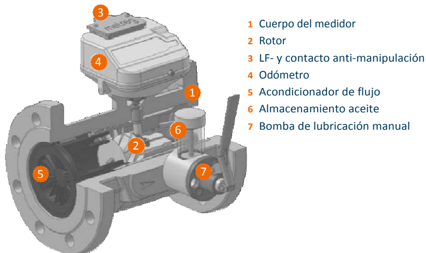
Fig. 1: Vista de sección de medidor MTM
