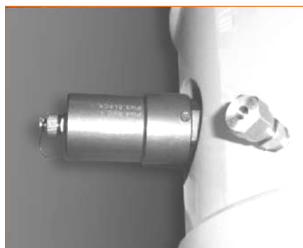
Figure 7: Sensor HF instalado en la turbina
